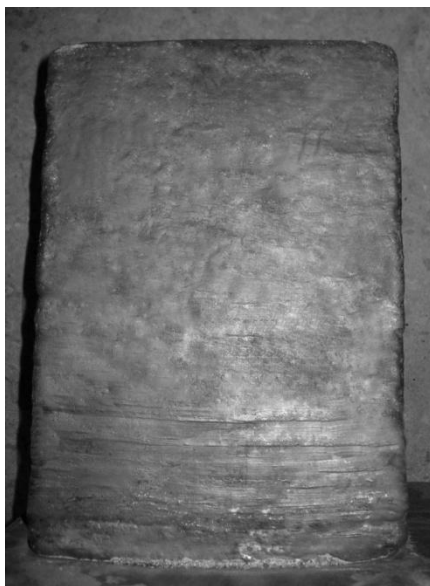
Рис. 2. Стан поверхні злитка при переплаві розщепленого електрода з геометричним коефіцієнтом заповнення 0,37
